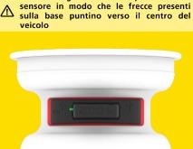
Inserire la fascetta a doppia chiusura da 9 mm di spessore e con una lunghezza minima di 360 mm nei fori predisposti nel sensore e stringere la fascetta con l'apposita pinza
